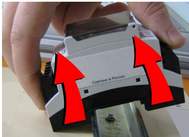
Рисунок 6 – Демонтаж модуля с DIN-рейки
