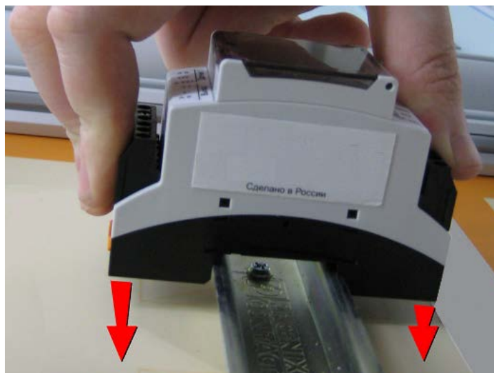
Рисунок 4 – Монтаж модуля на DIN-рейку
