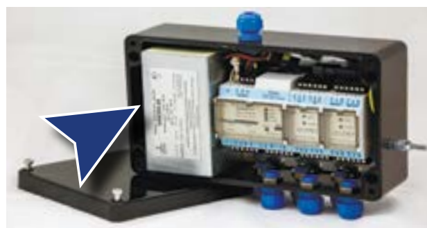
АКТЕЛ-2 в составе автономных систем телеметрии ГРП/ШРП
