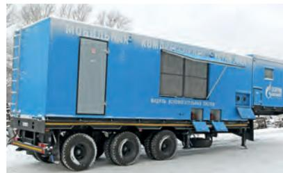
Рис. 4. Модуль вспомогательных систем МКС «МКУ-МТ/ГП»
