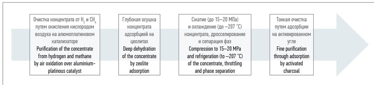
Рис. 3. Схема очистки концентрата гелия
