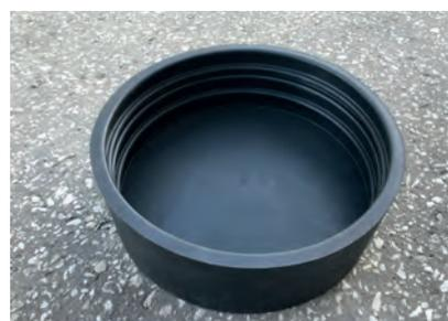
Рис. 3. Опытный образец герметизатора (Ди 325 мм)
