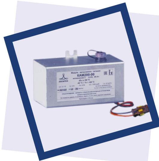
КАМ200-00 является электрооборудованием с видом взрывозащиты «искробезопасная электрическая цепь» "ic" для применения во взрывоопасных газовых средах подгруппы IIB температурного класса T5, температурой самовоспламенения более 100 °С. Модули имеют встроенный стабилизатор напряжения и схему защиты. Сохраняют работоспособность в температурном режиме от -40 до +60 °С благодаря использованию специального химического соединения.
